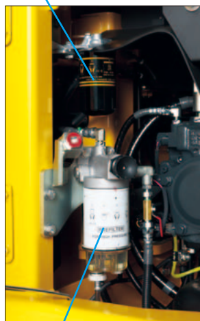
ウォーターセパレータ機能付 燃料プレフィルタ
